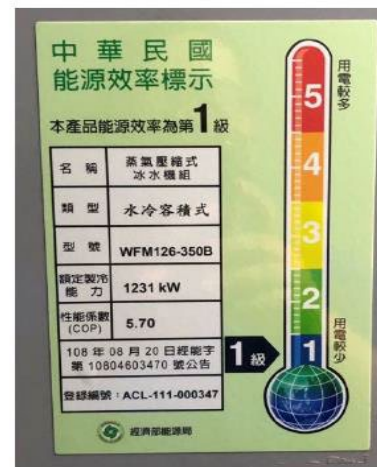
冰水機組的能源效率標示照片
