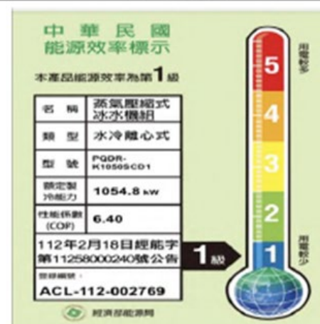
冰水機組的能源效率標示照片
